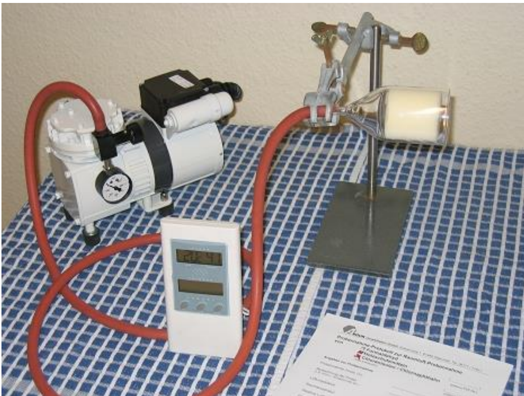
Abb. 1: Probenahme mit PUF-Sammler (z.B. Holzschutzmittel, Geruchsstoffe)
